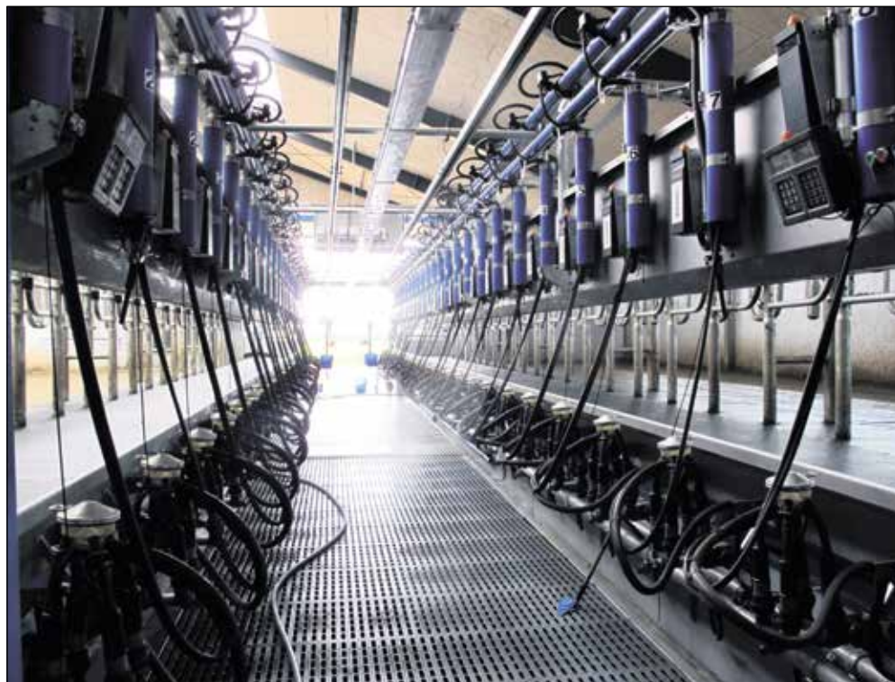
Malkecentret består af den 2x24 »side-by-side« malkestald, der gør det muligt at malke de 250 køer, uden at de kommer til at stå alt for længe og vente på opsamlingspladsen.
