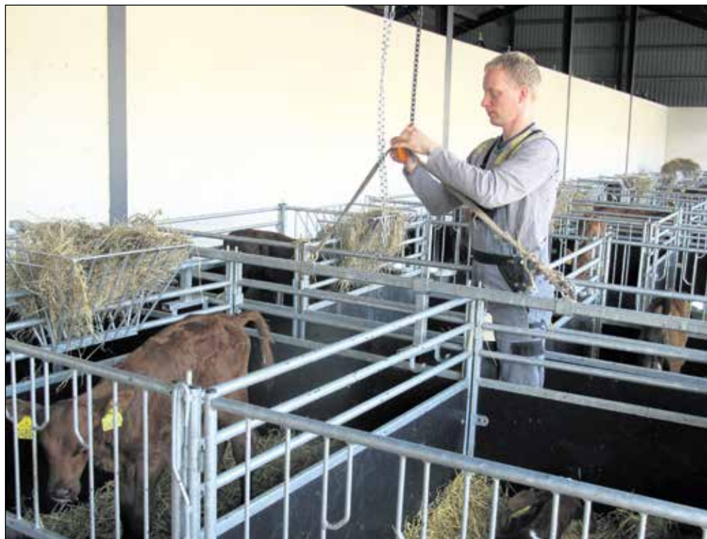
Kalveboksene kan nemt løftes af en mand ved hjælp af denne talje i forbindelse med rengøring.
